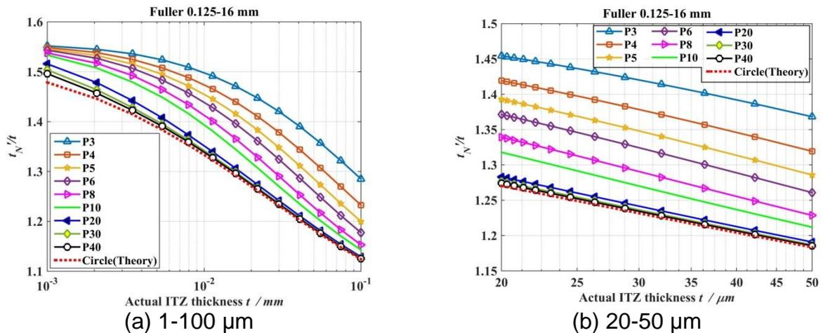
Fig. 9 Effect of actual ITZ thickness on  $t'_N/t$
