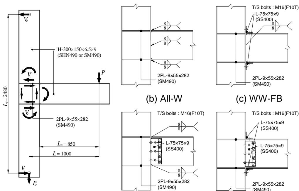
(a) Shape of specimen (d) WB-FW (e) All-B
